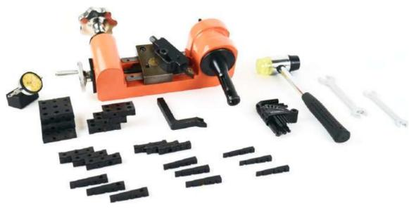
Ручной станок для обработки фланцев
